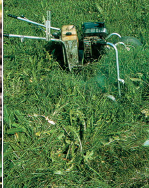
Topcat-Falle und Benzinvergaser an der Arbeit. Vorsicht: Den austretenden Rauch nicht einatmen – er enthält einen beträchtlichen Anteil an sch
