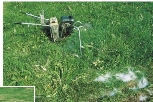
*Begasung eines Wühlmausgangsystems mit einem Benzinvergasungsapparat.*
