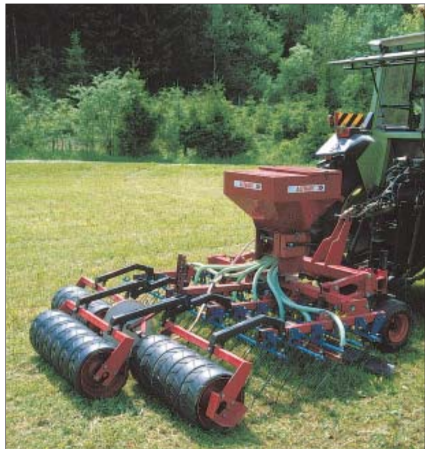
SEMOIR Hatzenbichler avec rouleau en action dans un pré présentant un feutrage important.
